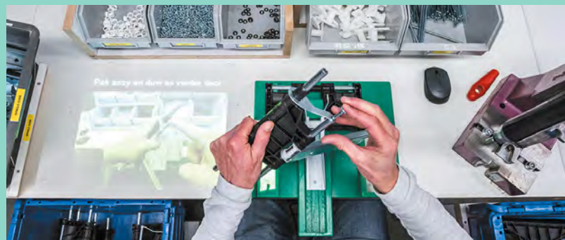
Werkplek met Operating Support Systeem (OSS) dat instructies projecteert via beeld, tekst en licht.
